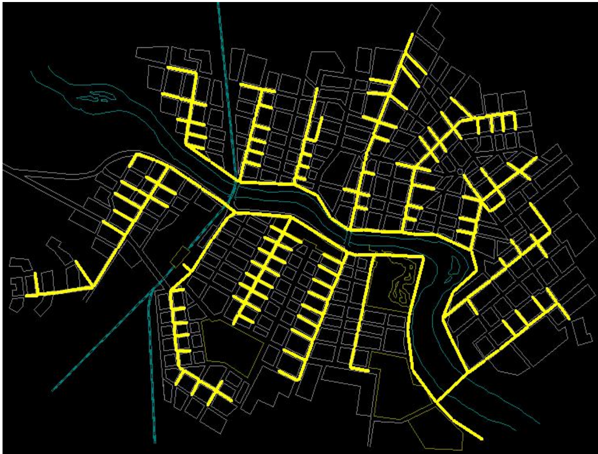
图 2.2 污水管网定线方案 2
