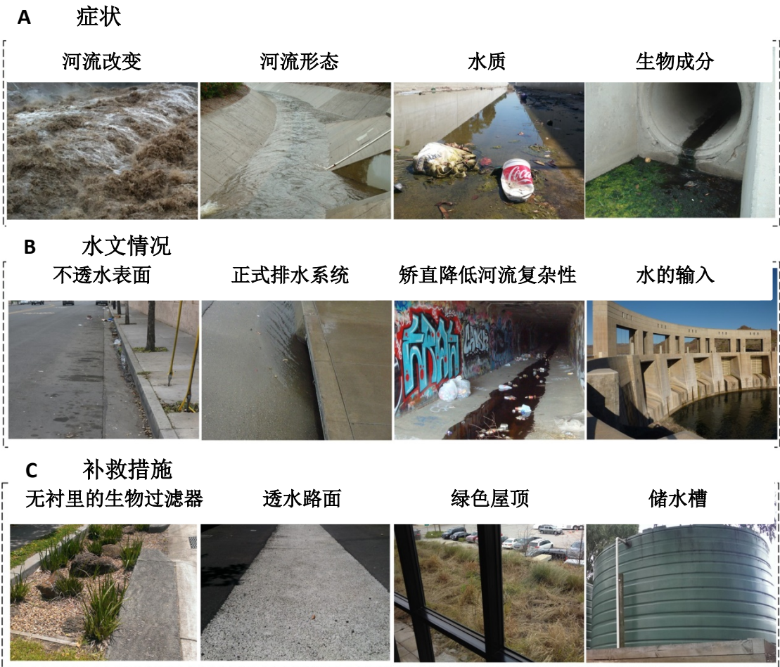
图 1. 与城市河流综合征相关的水文扰动的症状、原因和治疗 (A) 症状包括: (1) 河流改变 (基流、洪峰流、年径流量、流量变异性); (2) 河流形态改变 (河流宽度、深度、复杂性以及与河岸带、低流区和泛滥平原的分离); (3) 水和沉积物质量受损 (垃圾、营养物、溶解氧、毒物, 悬浮物、温度); 以及 (4) 生物成分的变化 (本地物种的减少、敏感物种的减少、耐性物种的增加、入侵物种的增加) 和生态系统服务的损失 (有机物的保留和加工、养分去除、初级生产和呼吸)。(B) 原因包括: (1) 用不透水表面 (如道路、停车场、屋顶和人行道) 代替草地和森林; (2) 建设雨水排放和防洪基础设施, 以将雨水快速输送至河流 (正式排水系统); (3) 通过掩埋、矫直降低河流复杂性, 以及混凝土衬砌河流; 以及 (4) 通过水的输入、碎石坝的建造和地表水的蓄水来改变水和泥沙的总体预算。(C) 可能解决与城市河流综合征相关的水文挑战
