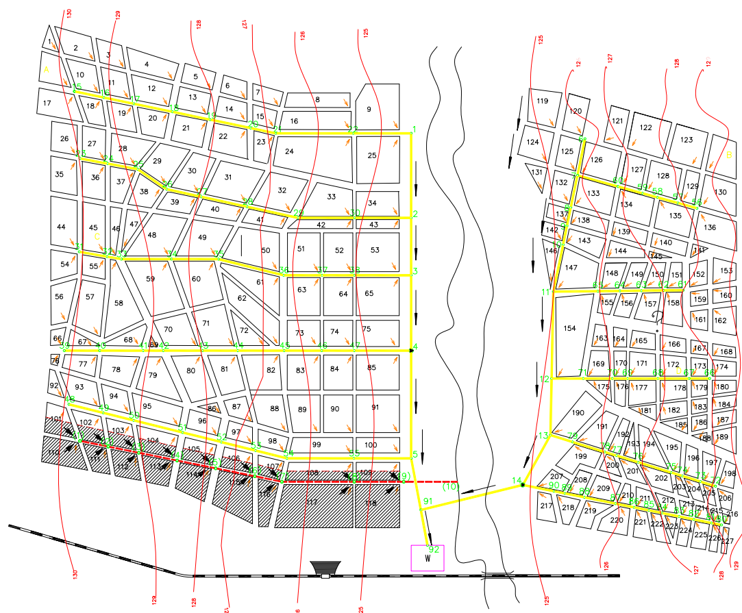
图 2.1 污水管网节点与管段布置示意图
