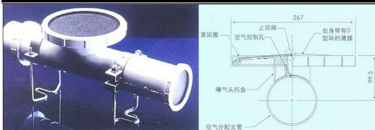
图 4.13 Sanitaire 曝气头
