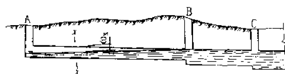
图 3-6 雨水管道的空隙容积
