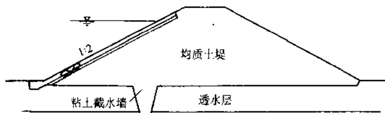
图 6-63 均质土堤粘土截水墙
