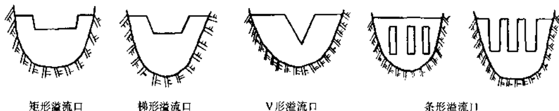
图 9-4 拦挡坝的溢流口
