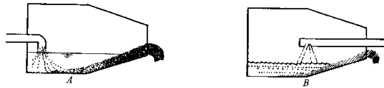
图 8-50 低、高速离心机工作原理比较 A—低速离心机; B—高速离心机
